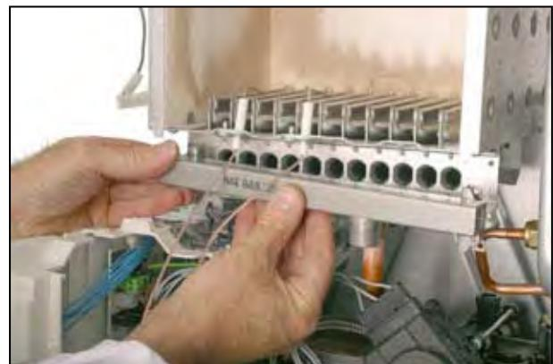
6. Выкрутить два винта, крепящие горелку к камере сгорания;
