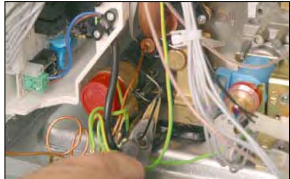
2. Демонтировать предохранительный клапан.
