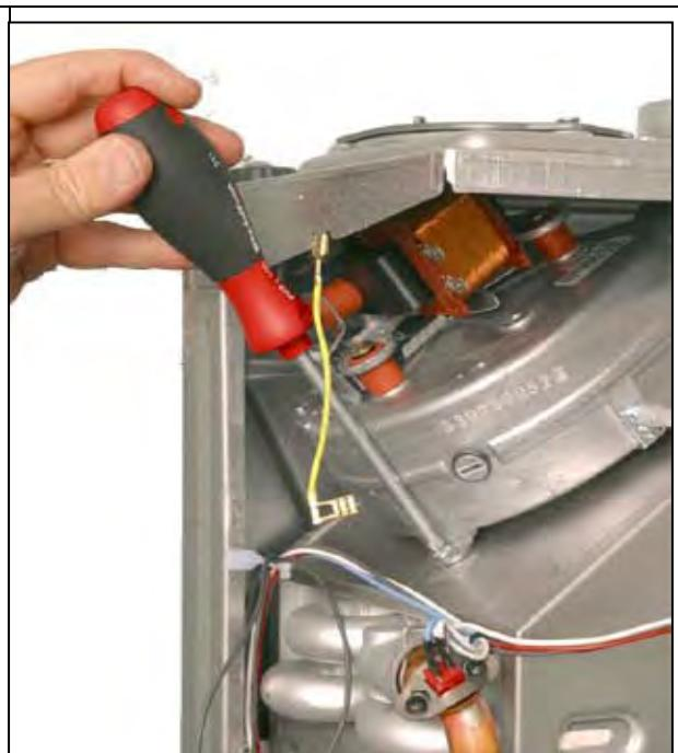
2. Теперь есть возможность снять вентилятор.
